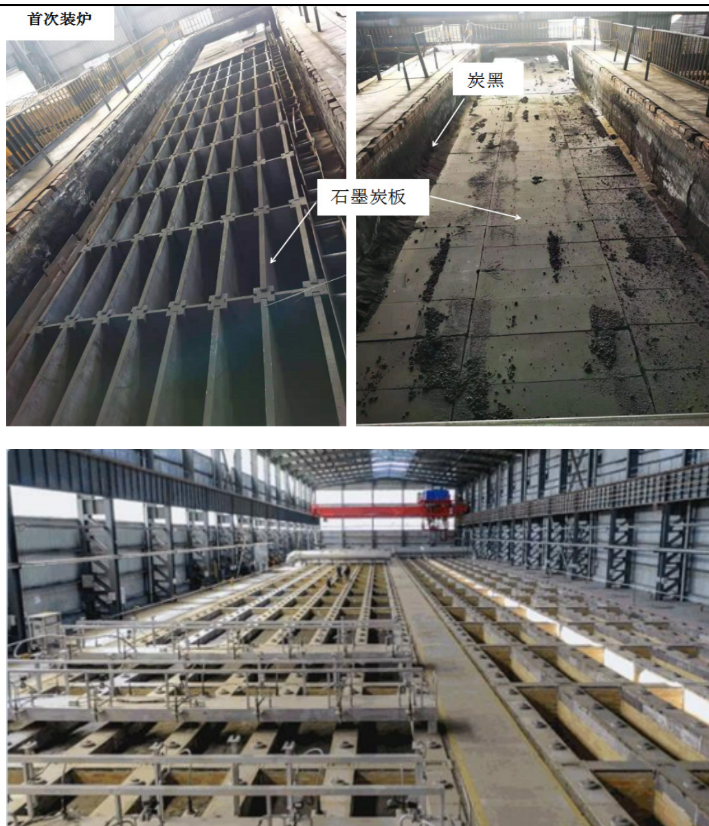
图 2.2.1-5 石墨化装炉部分工序示意图（同类企业）
