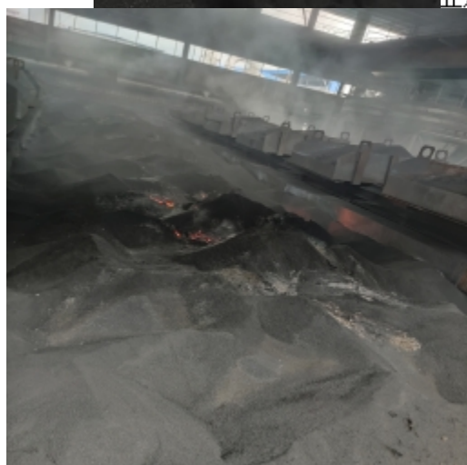
图 4.2.1-3 低温阶段废气点火燃烧处理及自然冷却阶段（同行业其他企业）
