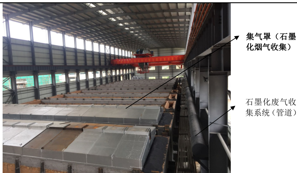
图 2.2.1-6 箱式石墨化炉（同类企业/正常生产运行）示意图
